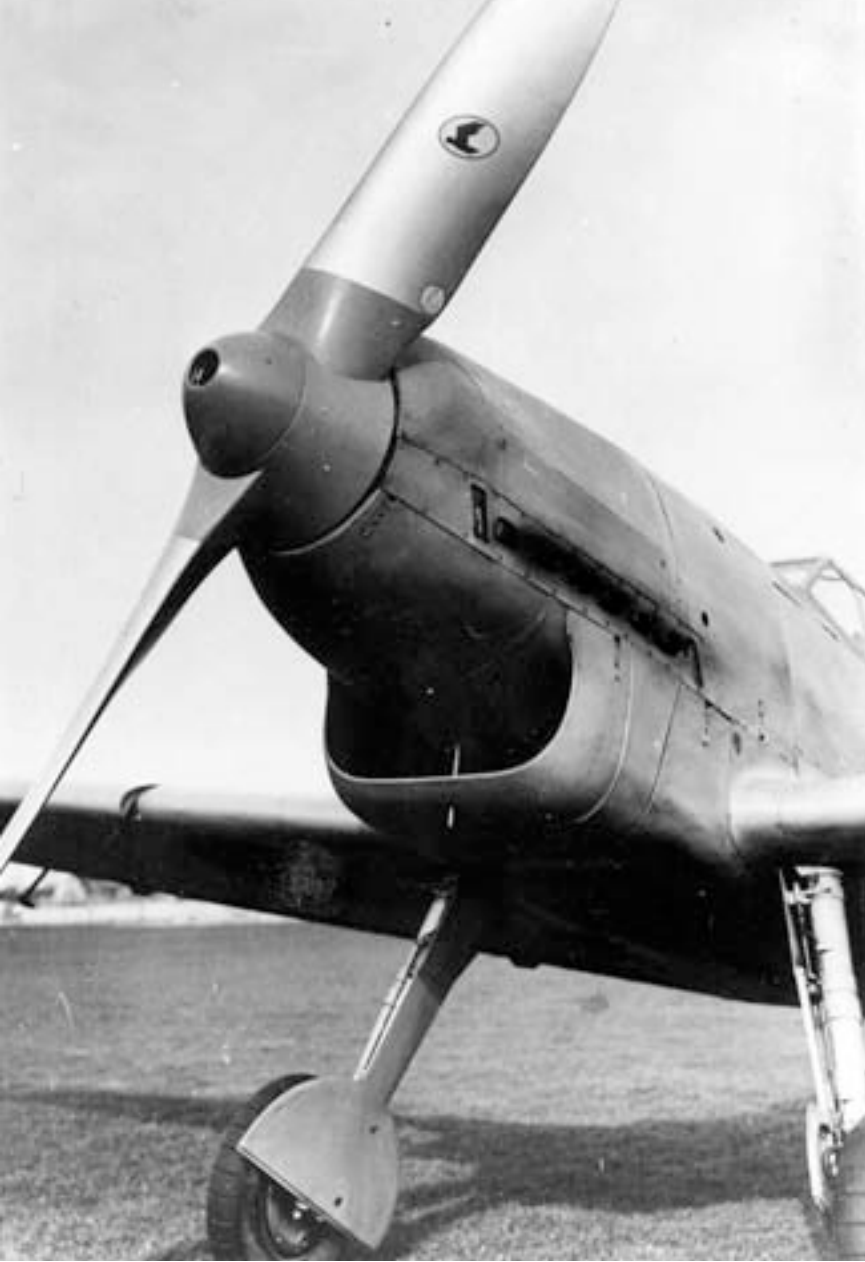
Die Luftschaube einer Me 109 B. An der Tragfläche ist der Vorflügel ausgefahren. (Foto Archiv Airbus Defence)
