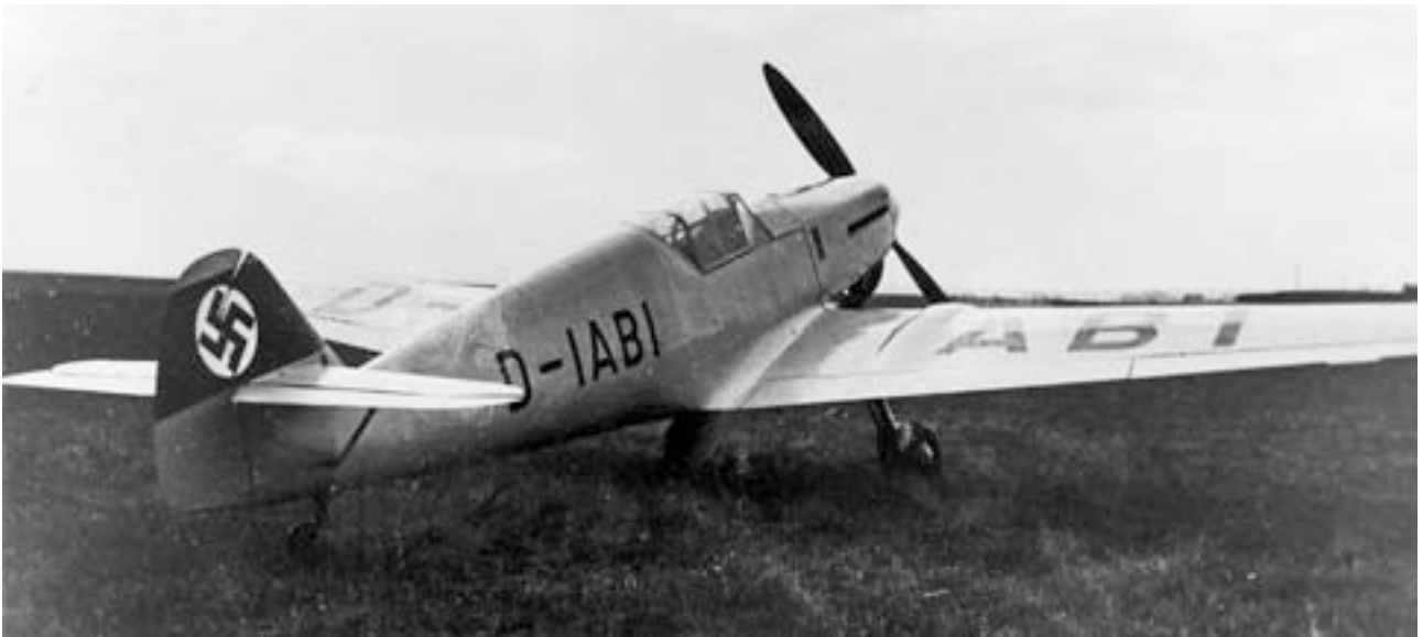
Die V-1 von hinten rechts aufgenommen. Aufgrund des schmalen Tragflächenprofils ist auf der Tragflächenoberseite eine Ausbuchtung zur Aufnahme des Hauptfahrwerkstrahles erkennbar, wie es dann ab der Me 109 G-4 sowie bei der G-10, G-14 AS und K-4 erforderlich war.
