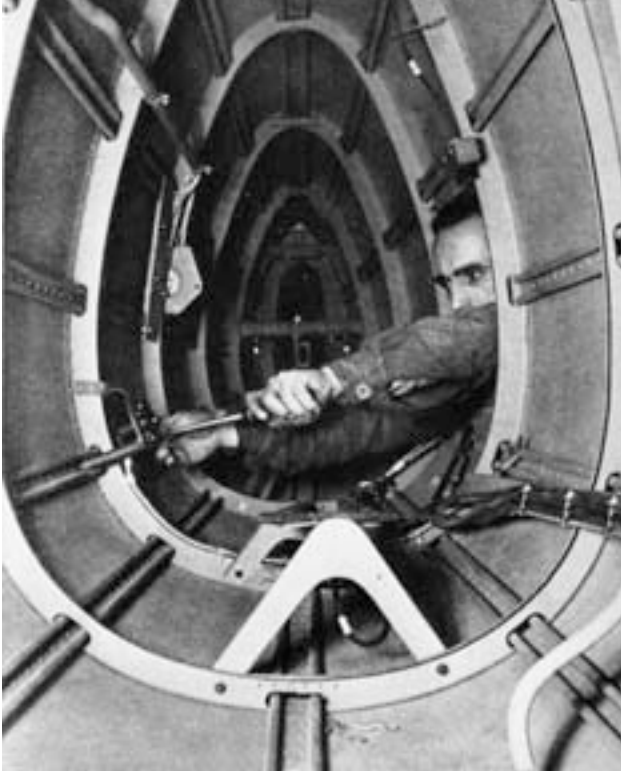
Blick in den Rumpf einer Me 109. Die Längsurte verbinden die Rumpfhälbschalen. Durch diese Konstruktionsweise und das verwendete Dural ergab sich ein außerordentlich stabiler Rumpf bei geringem Gewicht. Für die Beplankung von Flugzeugen wurde das sehr korrosionsbeständige Duralplatt verwendet. Duralplatt hatte einen Duralkern. Bei einer Temperatur von 400°C wurde auf beiden Seiten eine kupferfreie Aluminium-Legierung aufgewalzt. Duralplatt hatte die Fliegwerkstoff-Kennzahl 3116. (Foto Archiv Airbus Defence)
