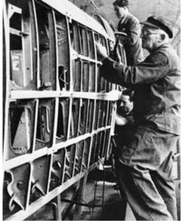
Blick in die Tragflächenmontage. Deutlich ist der konstruktive Aufbau mit Spanten und Rippen zu erkennen, die aus Dural hergestellt wurden. Durch Aushärten erreicht das Dural eine Zugfestigkeit von 46 – 52 kg/mm 2 . Dies entspricht der Festigkeit von Stahl, aber bei nur einem Drittel des Gewichtes. Dural besteht zu 95% aus Aluminium, zu 4% aus Kupfer; der Rest aus Magnesium und Mangan. Holme, Rippen, Steuerwerk und Nieten wurden aus Dural hergestellt. Fliegwerkstoff-Kennzahl 3115 oder 3125. (Foto Archiv Airbus Defence)
