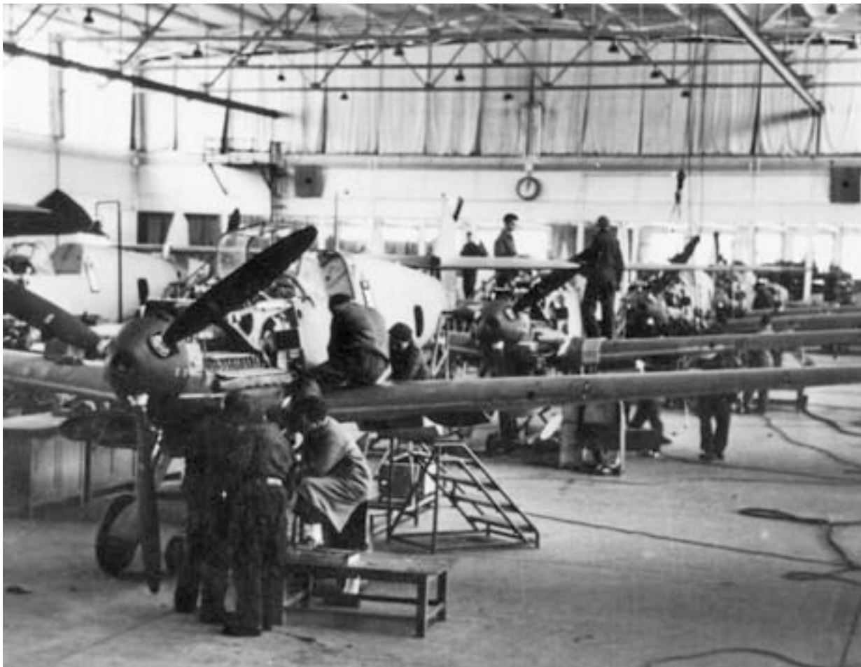
Endmontage der Me 109 E-3. Die Tragflächenbe- waffnung ist noch nicht eingebaut.
