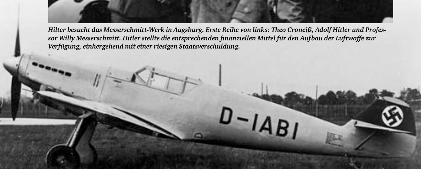
Die Me 109 V-1 steht in Augsburg zum Einflug bereit. Schon diese Aufnahme zeigt deutlich, dass die Me 109 auf Geschwindigkeit ausgelegt ist und einen völlig neuen Entwurf gegenüber bisherigen Flugzeugen, wie im Hintergrund links erkennbar, darstellt. Als Triebwerk ist ein Motor vom Typ Rolls-Royce Kestrel eingebaut, da der Junkersmotor vom Typ Jumo 210 noch nicht zur Verfügung stand.
