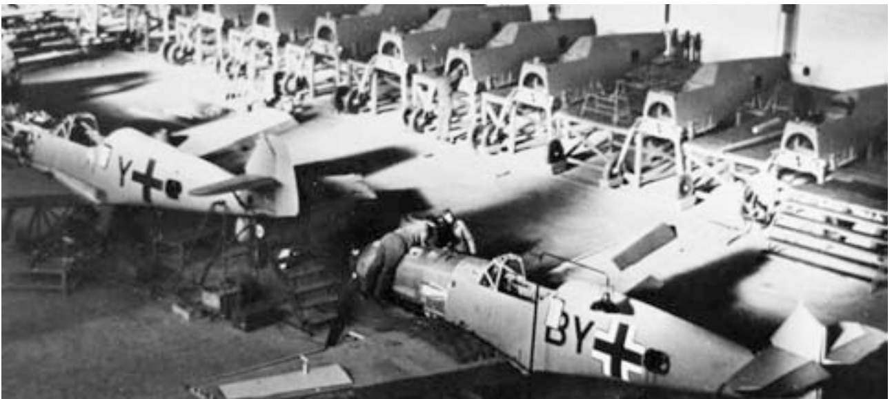
Diese Aufnahme zeigt die Rumpfmontage im Hintergrund und die Endmontage der Me 109 E im Regensburger Werk 1939. Zu diesem Zeitpunkt wird noch im Taktverfahren gearbeitet. (Foto Archiv Airbus Defence)
