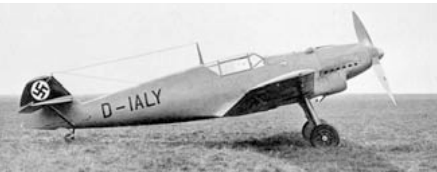
Me 109 V-4, D-IALY, Werknummer 878, mit einem Jumo 210 Motor und der festen Holzluftschraube der Firma Schwarz.
