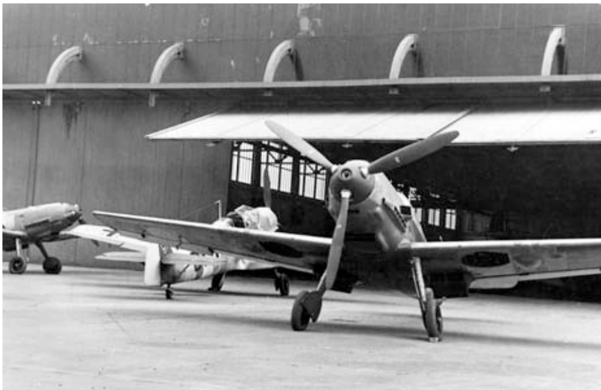
Me 109 E-3 vor der Endmontagehalle in Regensburg. Die Tragflächenbewaffnung ist bei der vorderen Maschine noch nicht eingebaut.
